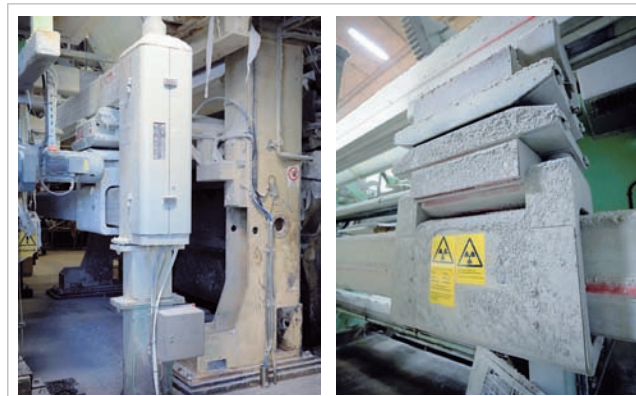
Dva snímače merajúce vlhkosť a hmotnosť vlákien boli na papierenskom stroji PM8 nahradené jedným snímačom s infračervenou technológiou HPIR-FW.
